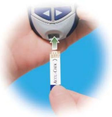
1. Inserte una tira reactiva en el medidor en la dirección indicada por la flecha. El medidor se enciende.
