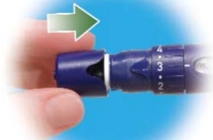
**3.** Deslice el capuchón hasta que la muesca del capuchón esté alineada con la del dispositivo de punción.
