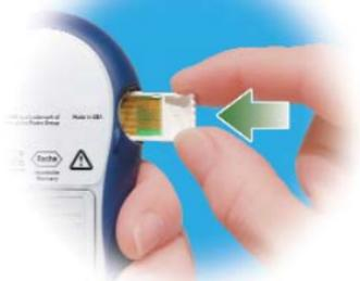
4. Dé la vuelta al chip de codificación de forma que no vea el número del código. Introdúzcalo en el medidor hasta que encaje.
